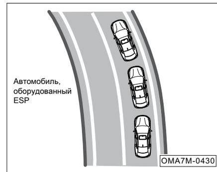
Автомобиль с ESP сможет регулировать тормозное усилие во время бокового скольжения и предотвратить отклонение от нормальной траектории.
