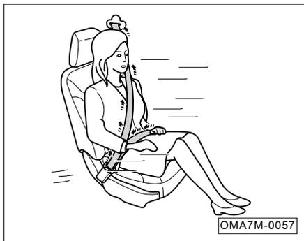
Ограничитель усилия предварительного натяжения ремня безопасности помогает снизить давление ремня на грудь водителя или пассажира и улучшить защиту при ударе.
