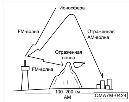
Ультракороткие FM-волны проходят сквозь ионосферу, не отражаясь от нее. Однако они могут отражаться от гор, высотных зданий и прочих подобных препятствий. Дальность распространения частотно-модулированного FM-сигнала обычно составляет 40–50 км. Стереосигналы распространяются на меньшее расстояние.
