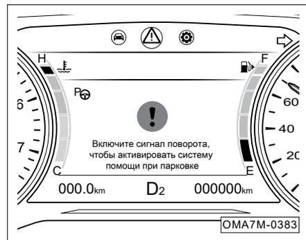
1. Включите заднюю передачу и указатель поворота (в соответствии с направлением, в котором собираетесь выезжать). Нажав на переключатель системы полуавтоматической парковки P с иконкой руля, активируйте функцию параллельной парковки.
